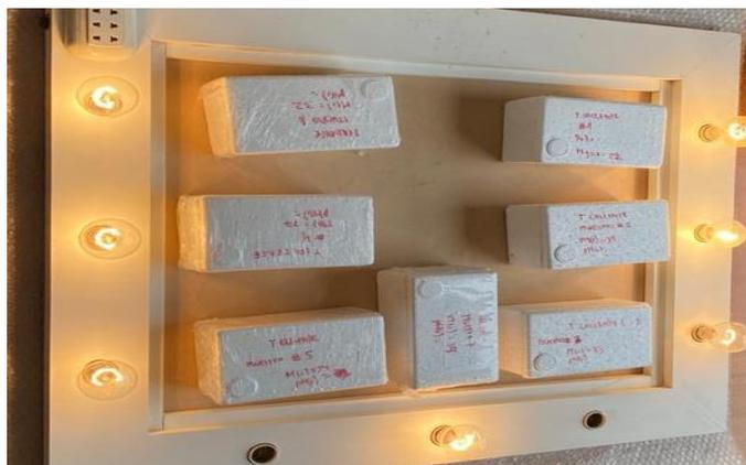
**Imagen 2: Montaje de experimentación a temperatura alta (22°C) con focos tradicionales.**
