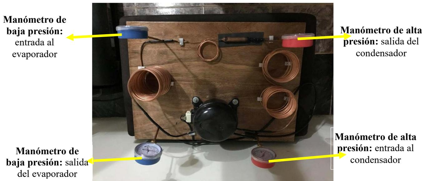
**Ilustración 3: Localización de los cuatro manómetros**
